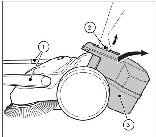
**Abb. 11: Kehrgutbehälter entleeren**
