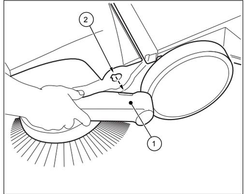
**Abb. 14: Schiebebügeldemontage (haaga 477 / 497 Profi)**
