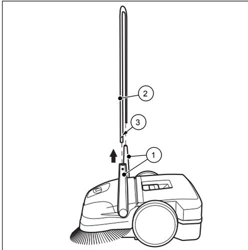
**Abb. 13: Schiebebügeldemontage (haaga 375)**
