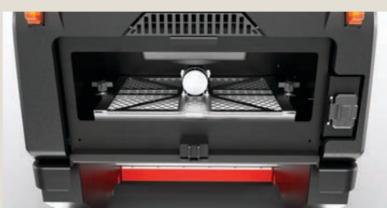
Entfernen Sie das hintere Filtergehäuse, um den Filter zu überprüfen, bauen Sie das Gehäuse und den Kehrgutbehälter wieder ein.
