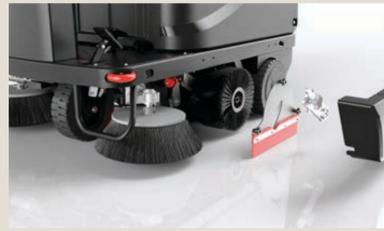
Achten Sie darauf, dass der Hauptbesen und die Seitenbesen korrekt installiert sind.
