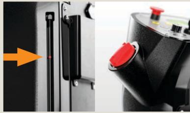
Überprüfen Sie den Wasserfüllstand an der Seite der Maschine. Füllen Sie bei Bedarf frisches Wasser nach, indem Sie die rote Kappe an der Einfüllöffnung entfernen.
