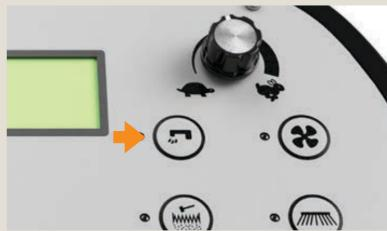
Drücken Sie die Wassernebel-Taste, um die Wassernebeldüse(n) für die Seitenbesen zu aktivieren, die bei staubigen Anwendungen oder im Freien verwendet werden.
