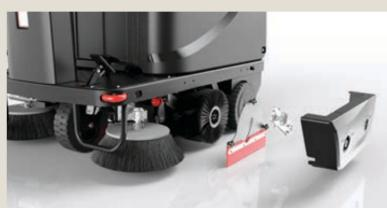
Entfernen, reinigen und inspizieren Sie den Hauptbesen und überprüfen Sie die Seitenbesen. Reinigen Sie die Maschine mit einem feuchten Tuch.
