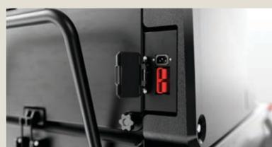
Laden Sie die Maschine über den hinteren Ladeanschluss auf. Sie verfügt über zwei Anschlüsse, einen für ein externes Ladegerät und einen weiteren, sofern ein On-Board-Ladegerät installiert ist.
