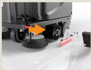
1. Überprüfen Sie den Hauptbesen, stellen Sie sicher, dass er sich dreht und nicht abgenutzt ist. Passen Sie bei Bedarf den Besendruck an.
