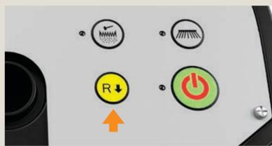
Drücken Sie die Rückwärts-Taste, um die Kehmaschine rückwärts zu fahren. Bei Rückwärtsfahrt kehrt die Maschine nicht.
