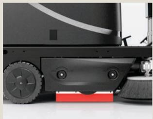
1. Überprüfen Sie, ob alle Gummiseitenleisten korrekt eingestellt und nicht beschädigt sind.
