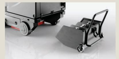
Drücken Sie die OneTouch™ Taste, um alle Funktionen zu stoppen. Lösen Sie langsam den Verriegelungsmechanismus des Kehrgutbehälters, da er schwer sein kann. Mit dem Griff den Kehrgutbehälter entfernen und entleeren.
