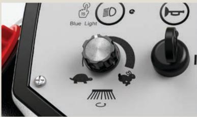
Stellen Sie die Geschwindigkeit der Seitenbesen durch Verstellen des Geschwindigkeitsreglers ein.
