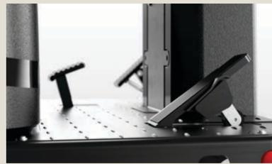
Die Bürsten und der Sauger starten, wenn das Fahrpedal betätigt wird, und beginnen den Kehrprozess.
