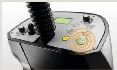
Drücken Sie die OneTouch™ Taste, um alle Kehrmaschinenfunktionen zu aktivieren. Die Besen werden automatisch abgesenkt.
