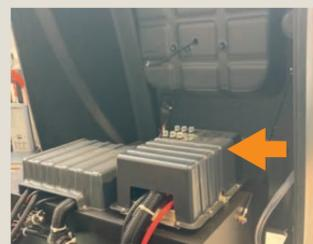
3. Öffnen Sie die Maschinenabdeckung und überprüfen Sie die Sicherungsschalter für die Besen.
