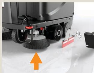
2. Stellen Sie die Seitenbesen bei Bedarf ein; ersetzen Sie die Seitenbesen, wenn die Borsten abgenutzt sind.
