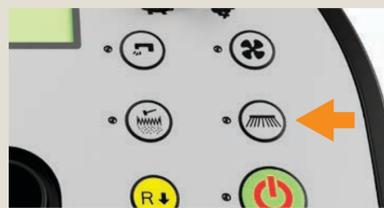
Drücken Sie die Taste für den Seitenbesen, um die Seitenbesen anzuheben und die Maschine nur mit dem Hauptbesen zu benutzen.
